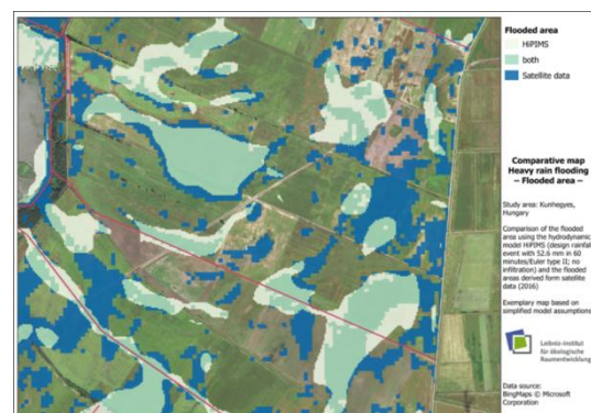
Gefährdungskarte basierend auf einer hydrodynamischen Simulation (Level 3) für Kunhegyes, Ungarn, und Vergleich mit beobachteten (Satellitendaten) Überflutungsgebieten; © Axel Sauer, IÖR
