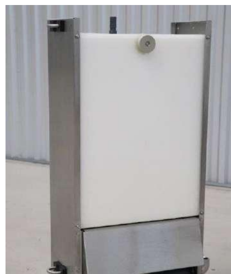
Slika 16: Potopljeni ultrafiltracijski sustav (AQQA®) za membranske bioreaktore kod kojeg su membranske ploče poravnate u kutiji u kojoj se mogu slagati jedna na drugu (izvor: Weise Water GmbH).
