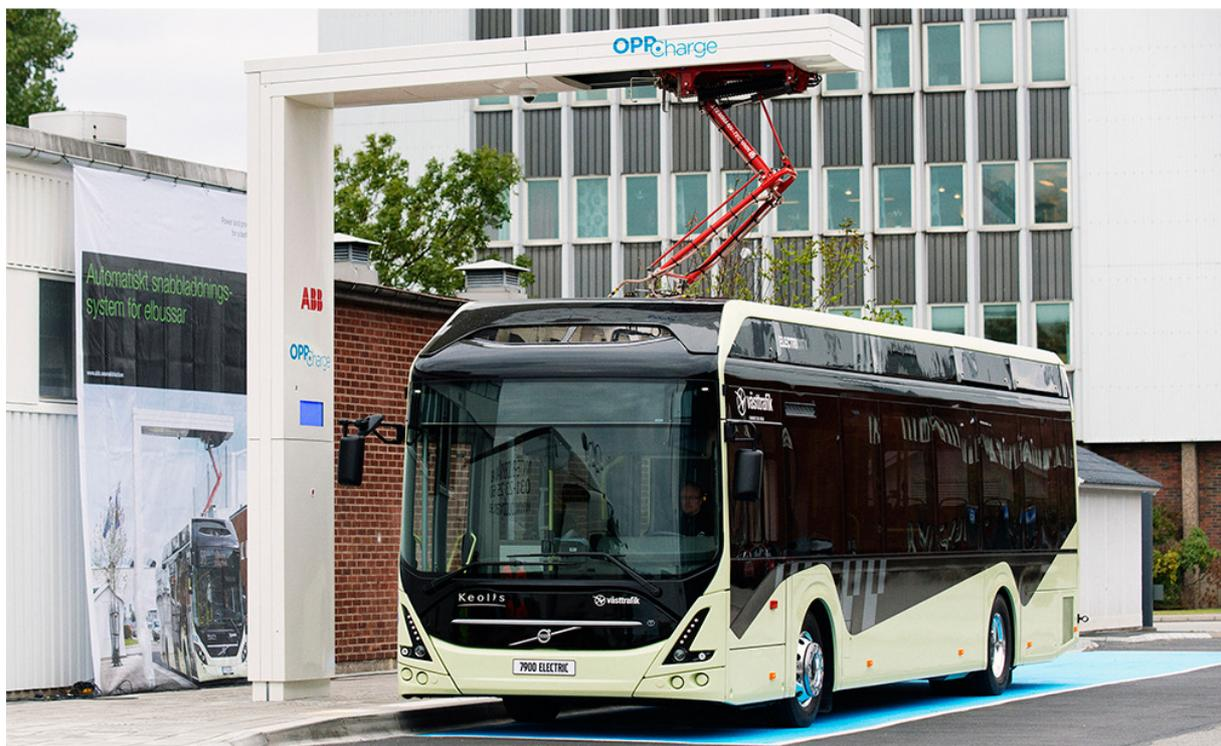
28. ábra: Példa pantográfós alkalomszerű töltési megoldásra (Varnamo, Svédország)<sup>21</sup>
