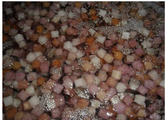
Rysunek 13: Napowietrzany reaktor z ruchomym złożem biologicznym (MBBR) (po lewej) i kostki z pianki jako nośnik (fot: E. Nolde).
