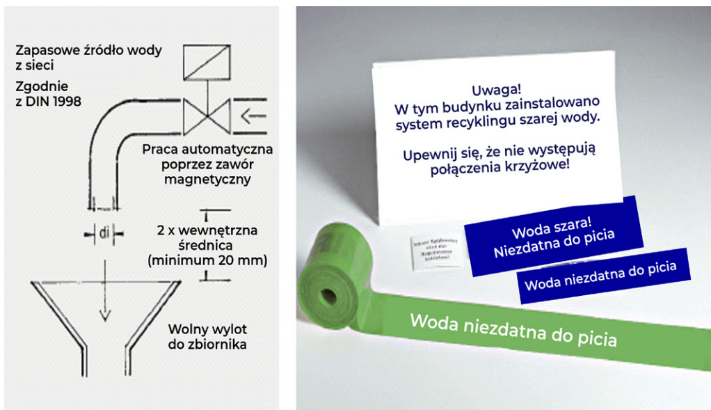
Rysunek 6: Schemat przedstawiający rezerwowe źródło wody (po lewej) oraz materiały użyte do oznakowania rurociągów i punktów poboru sieci wody użytkowej (fbr).
