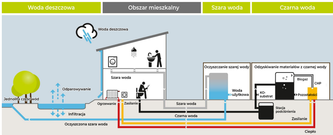
Rysunek 52: Koncepcja dzielnicy Jenfelder-Au w Hamburgu przedstawiająca różne strumienie ścieków 47 .
