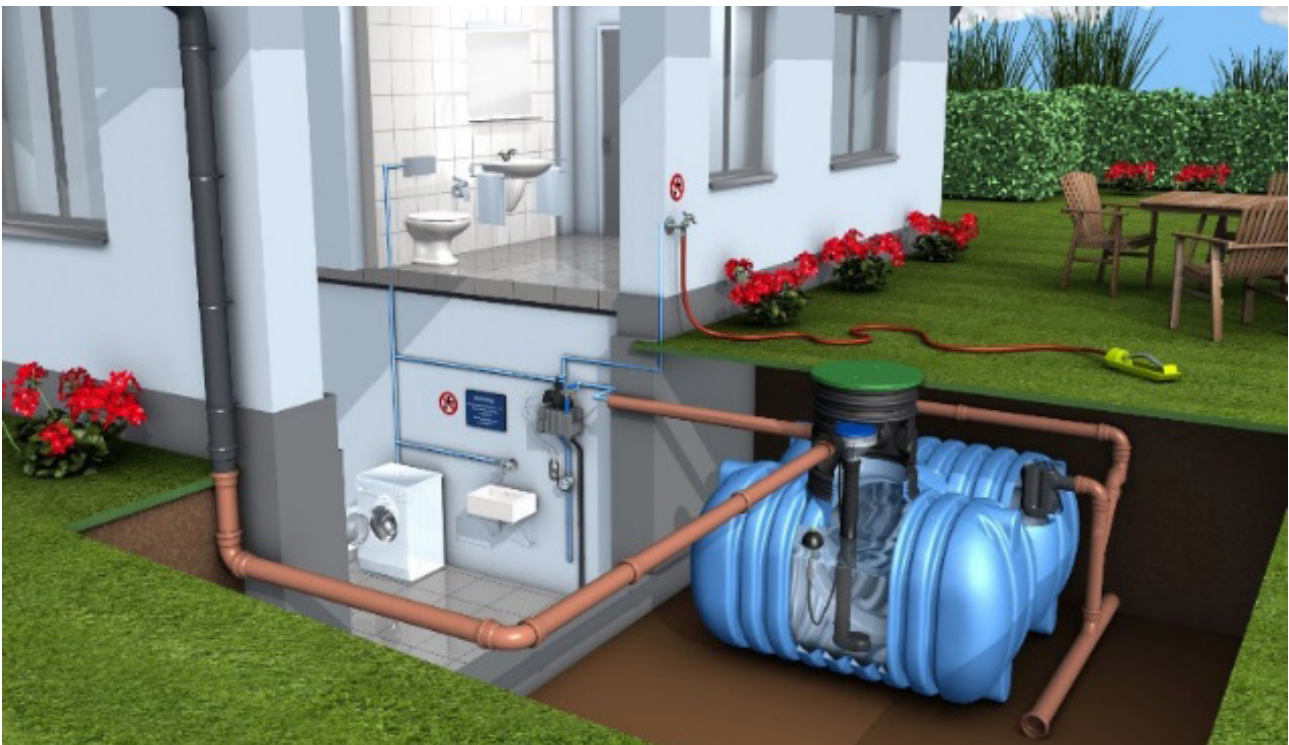
Rysunek 6: Schemat idealny podziemnego zbiornika na wodę deszczową do ponownego wykorzystania wody w pomieszczeniach i na zewnątrz (fbr).
