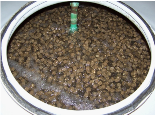
Rysunek 13: Napowietrzany reaktor z ruchomym złożem biologicznym (MBBR) (po lewej) i kostki z pianki jako nośnik (fot: E. Nolde).
