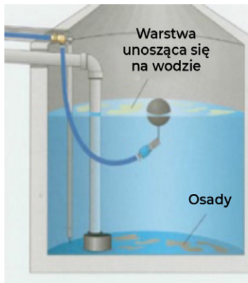
Rysunek 8: Urządzenie pływające z pompą ssącą dostarczające wodę do różnych punktów poboru.
