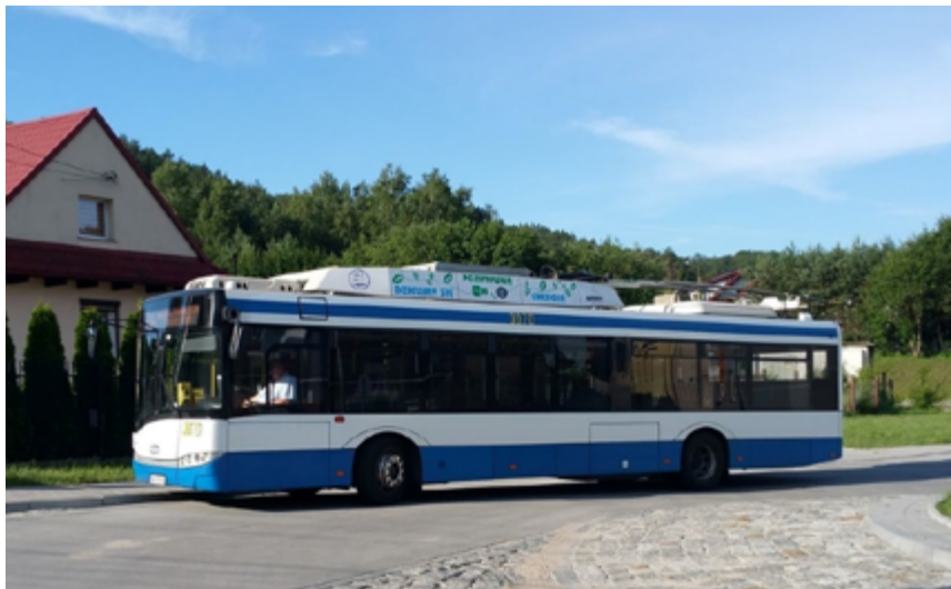
Slika 5: Trolejbus PKT Gdynia s sistemom polnjenja v gibanju v Gdinii (Avtor fotografije: Marcin Wolek)
