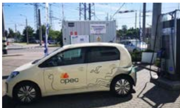
Slika 6: Mobilna polnilna postaja za električne avtomobile, ki se napaja iz trolejbusnega omrežja (PKT)
