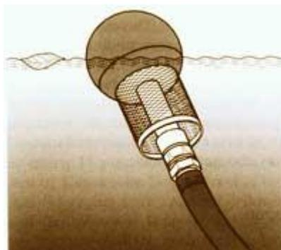
Un filtro di aspirazione fine galleggiante assicura che l'acqua piovana sia pompata dal livello più pulito del serbatoio e sia priva di particelle
