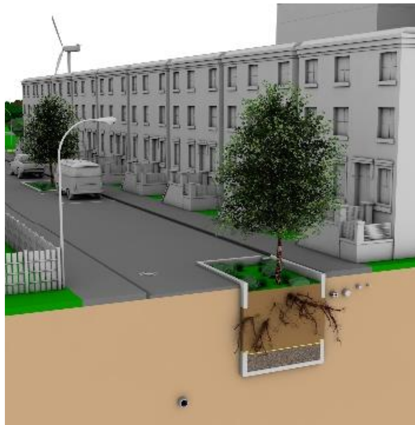
Shematski prikaz sistema drevesnih jarkov (Vir: Sieker)
