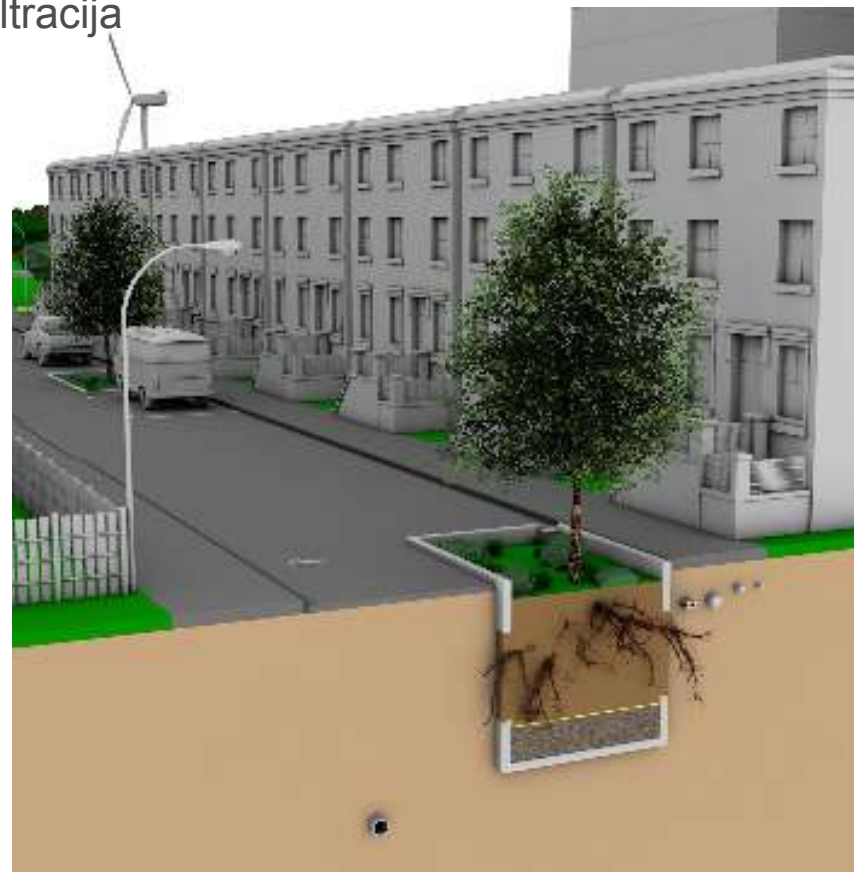
Shematski dijagram sustava infiltracijskog rovova sa stabalom (Izvor: Sieker)
