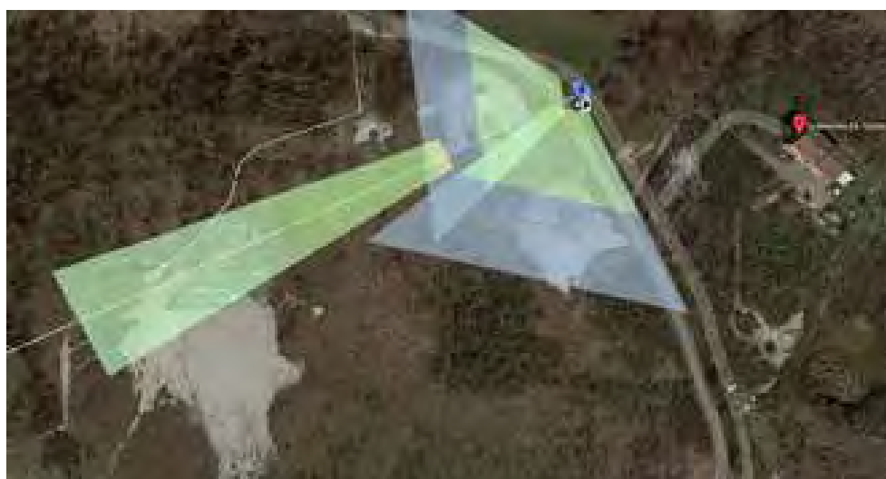
Fig.8: Sistema di analisi dei contenuti video (Video Content Analysis - VCA) che monitora i transiti lungo la strada di accesso. Archivio: Ente Parco dell'Emilia Centrale - Video esplicativo sistema NEMOS.
