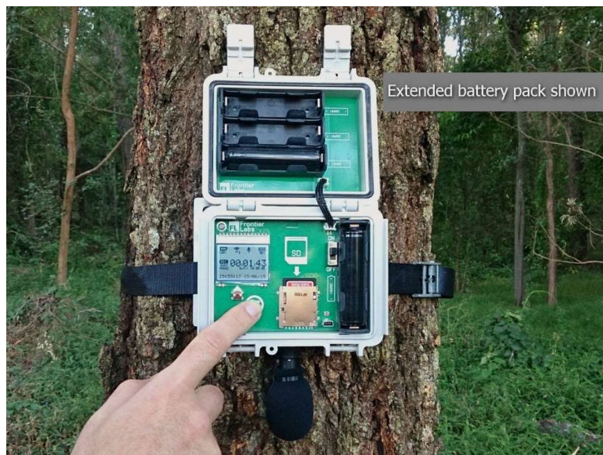
Sl. 37 - Primjer instalacije bioakustične opreme za snimanje. (Izvor: http://www.frontierlabs.com.au/shop/bioacoustics/bioacoustic-audio-recorder.html )
