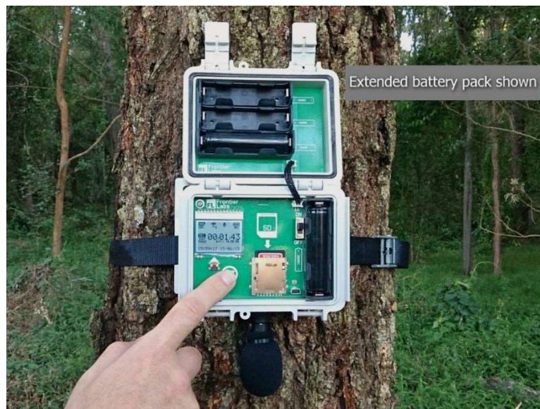
Primer postavitve naprave za merjenje zvoka (Vir: http://www.frontierlabs.com.au/shop/bioacoustics/bioacoustic-audio-recorder.html ).
