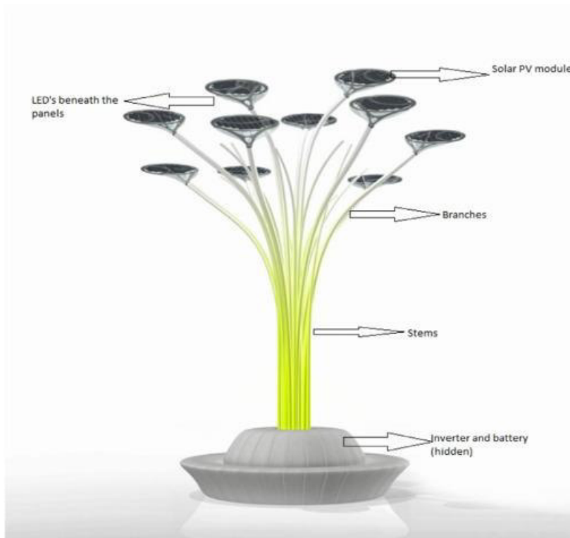
Slika 2: Predstavitev delov Solarnega drevesa
