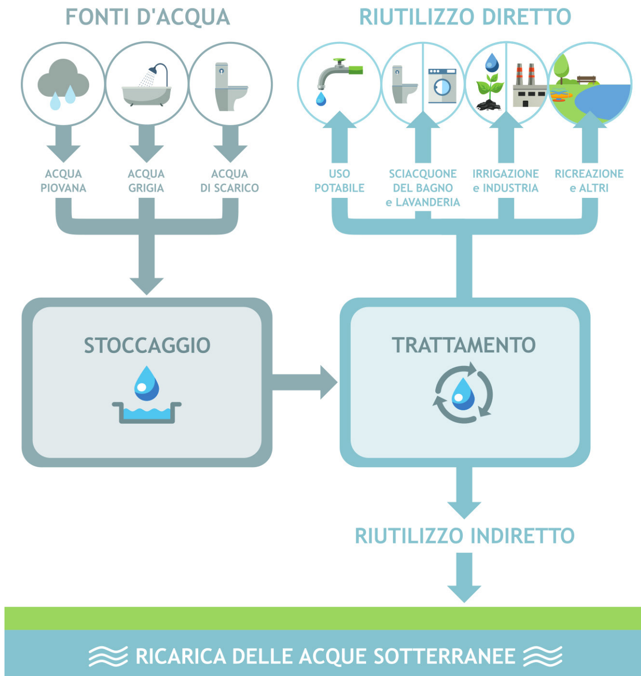
Figura 1: destino delle risorse idriche in un sistema di gestione circolare dell'acqua.
